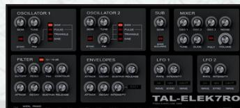
oscillatori alias migliorati, nuovi inviluppi rapidi ed LFO con un'ampia gamma da 0,1 Hz fino a 400 Hz. Questo synth è utile per una vasta gamma di suoni, da quelli percussivi a bassi profondi.
